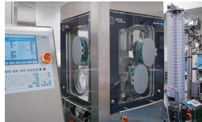
洗浄・乾燥を自動化したFette社製高速打錠機
